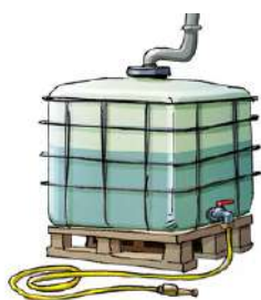
Cuve de récupération d'eau de pluie
